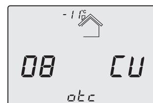
Pulsando los botones de calefacción (dets. 7 y 8 - fig. 1.2) se accede al desplazamiento paralelo de las curvas (fig. 1.4), modificable con los botones de agua sanitaria (dets. 1 y 2 - fig. 1.2).
